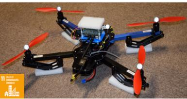
Drone aérien, issu de la plateforme robotique, utilisé pour valider des algorithmes mathématiques et dont l'usage est la surveillance des grands ouvrages
