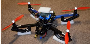
Drône aérien, issu de la plateforme robotique, utilisé pour valider des algorithmes mathématiques et dont l'usage est la surveillance des grands ouvrages
