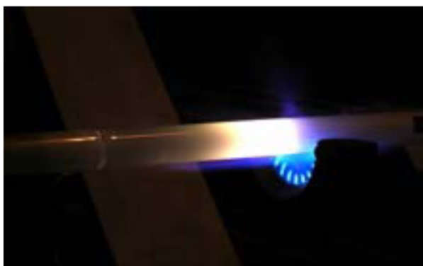
Fabrication d'une préforme par MCVD
